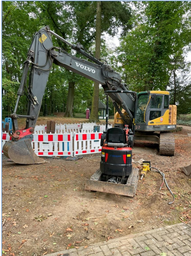
Oben: 0,7 t vs. 30 t - Geräteinsatz an Baggern
