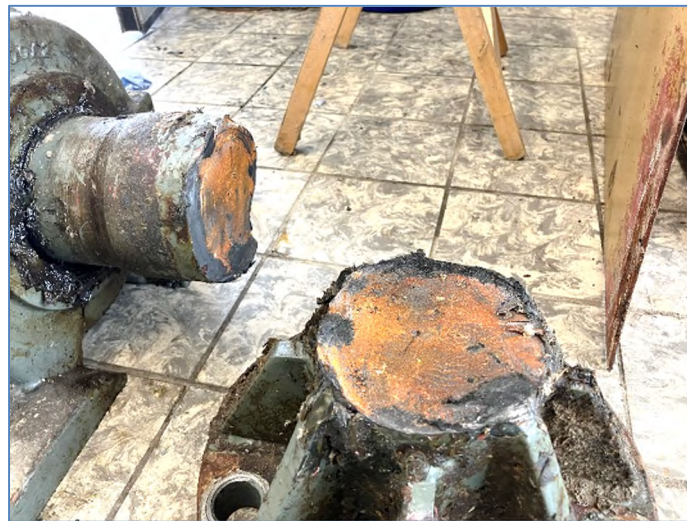
Nahaufnahme Bruchfläche am Lager - Ermüdungsbruch
